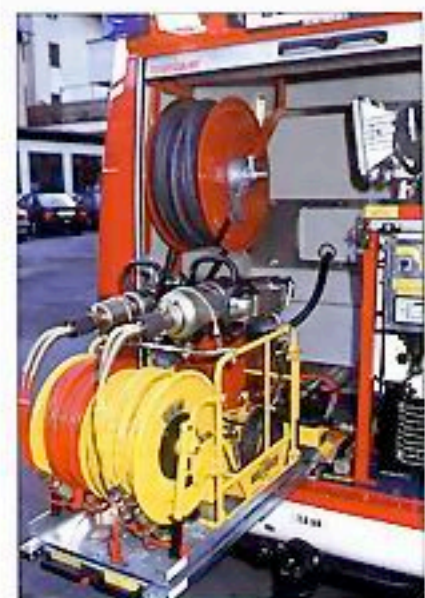
Voraurausrüstung: Zur Ausrüstung des VRF-A gehören Rettungssatz und eine 200-Liter-Poly-Löschanlage.
