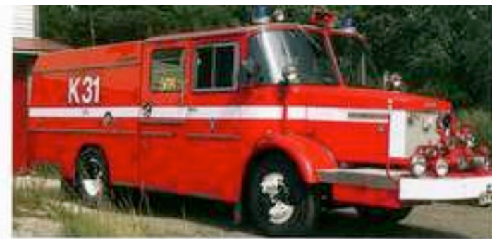
Rechts: Ein Sixt-Löschfahrzeug der Freiwilligen Feuerwehr Kooivla mit 2000 Liter fassendem Wassertank. Baujahr 1977, Aufbau/Fahrgestell Sixt-Kortis, Erfo-Pumpe.
